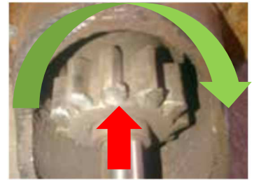
Todos los dientes muestran daños por un motor en funcionamiento
