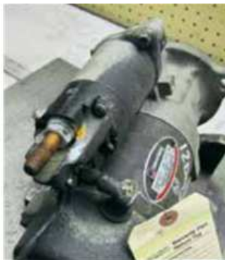
Automático auxiliar de control faltante
