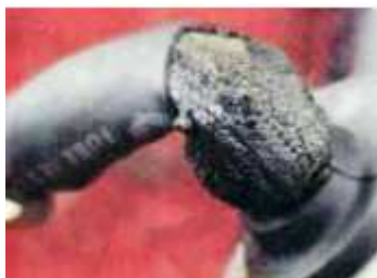
Látigo dañado por exceso de calor
