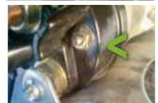
Buena terminal con tuerca de respaldo instalada de fábrica correctamente.
