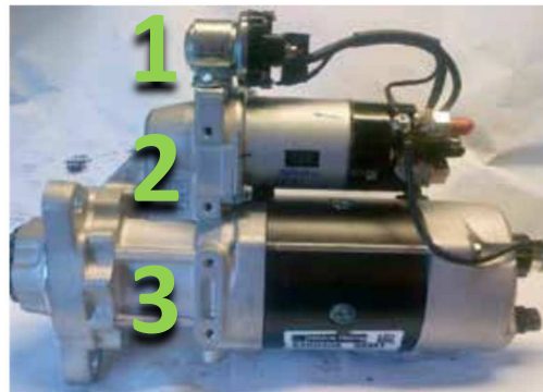
El automático auxiliar de control es armado en una de las posiciones en la tapa adelante del automático. Observe los cables que salen del automático
